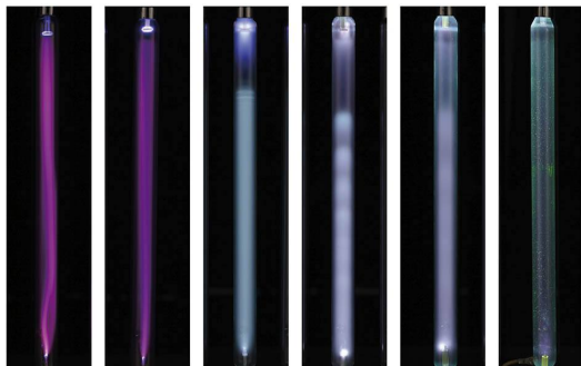
真空度 約5300Pa 約1330Pa 約400Pa 約133Pa 約18Pa 約4Pa
